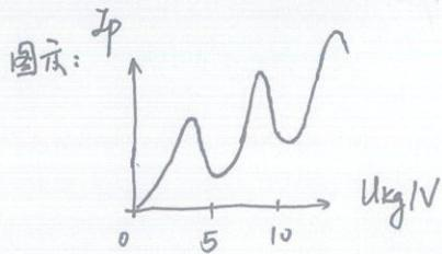
这一实验现象说明, 电压从零开始增加时, 电子动能也随之增加. 这时虽然电子与汞原子间有碰撞, 但这时属于弹性碰撞, 电子并不损失能量, 因而电流随电压增加而增加. 当电压超过 4.9 V 时.(15 Hg 为例), 电流突然下降, 说明电子与汞原子发生了非弹性碰撞, 电子使汞原子从基态跃迁到激发态. 电子因损失了动能而不能克服反向电压  $U_{gp}$  而阻滞到达极板 P. 从而电流下降. 如电压继续增加, 使碰撞电子动能仍大于  $1eU_{gp}$  时, 电子又能到达极板 P. 直至电压到达  $2 \times 4.9 V$ . 电子又会与汞原子发生非弹性碰撞,  $I_p$  再次下降.
