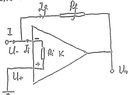
$R_f$  阻值较大， $R_i$  阻值较小， $K \gg 1$ 。 $U_- \approx U_+ \approx 0$ ，而  $U_o = I_f R_f$ ，可以通过改变  $R_f$  的大小达到放大电流的初衷。由于放大器具有很大的开环增益，所以可以有较小的输入阻抗。
