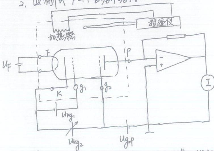
① 灯丝加热后, 使阴极 K 发射电子. K 上涂敷的特殊物质使其发射的电子数大于直热式阴极; ② 第一栅极  $g_1$  的电位略高于阴极 K 的电位, 用于消除热发射电子在阴极附近的空间电荷效应. ③ 第二栅极  $g_2$  与阴极 K 之间加一可变正电压, 使电子获得能量. 速度加快并在这个区域内不断与汞原子发生碰撞. ④ P 极板接收电子,  $U_{gp}$  的作用是使到达第二栅极  $g_2$  的能量较低而电子不能到达 P.
